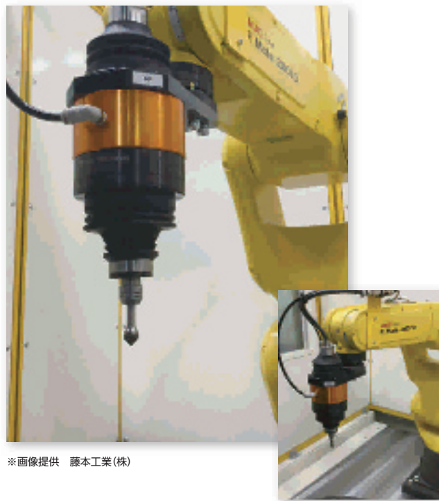
※画像提供 カトウ工機(株)DBR7-P 型バリ取りホルダー
